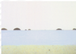
ПЕРЕОПЫЛ, ЧАСТИЦЫ ОКРАСОЧНОГО ТУМАНА НА ПОВЕРХНОСТИ
